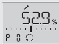
Le code **P0** s'affiche, le positionneur se trouve en fonctionnement de régulation, signalé par le symbole
