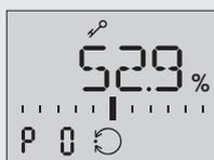
*Initialisation réussie, le positionneur est en fonctionnement de régulation, signalée par le symbole  $\curvearrowright$ .*
