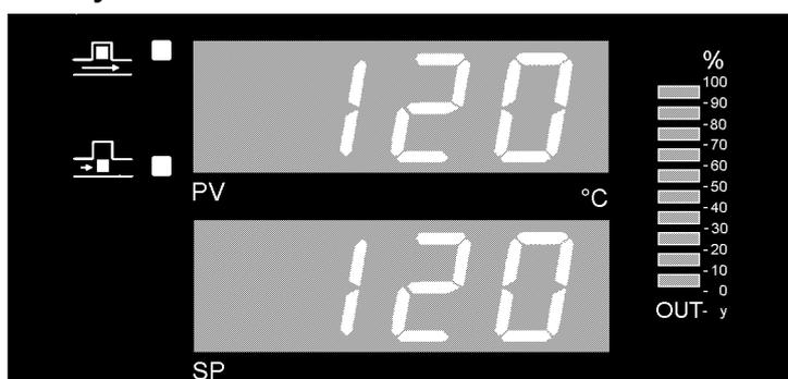
Sur le côté droit de la plaque frontale, le 6490B-y est équipé d'un affichage de bargraphes supplémentaire, qui montre la variable commandée Y. L'affichage de bargraphes peut être supprimé via le point de configuration Y.SY. La variable commandée Y est indiquée à pas de 10% comme suit :
