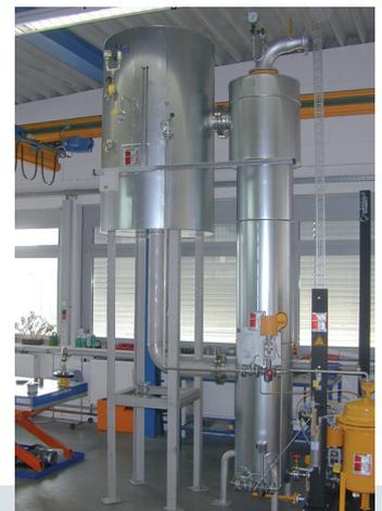
Baelz bietet eine Vielzahl von Varianten der Dampferzeugung: Liegend mit dampfseitiger Regelung und stehend mit kondensatseitiger Regelung. Die stehenden Ausführungen ein- oder zweiteilig, mit dem Vorteil einer wesentlich reduzierten Stellfläche. Zudem bieten stehende Ausführungen deutlich geringere Kondensat-Anstauzeiten sowie höhere Kondensat-Auskühlung. Stets integriert und fix und fertig verschaltet und geprüft sind Automatik-Funktionen für Niveau, Druck, Leitfähigkeit und das Abschlammen.
