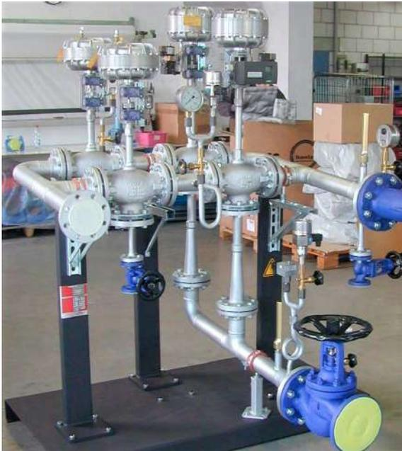
Dampfstrahlpumpensysteme können vormontiert auf einer Konsole (Bild oben) geliefert werden oder als Baelz-Anlage, die beim Kunden montiert wird.
