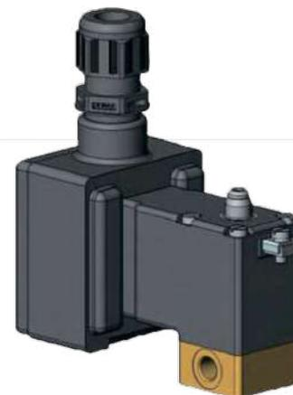
**Hinweis:** Explosionsgeschützte Magnetventile baelz 268/1-Ex und 268/2-Ex müssen bauseitig durch folgende mittelträge Sicherungen abgesichert werden: 230 V UC, 9W: 100 mA; 110 V UC, 9 W: 215 mA; 24 V UC, 9 W: 1000 mA.
