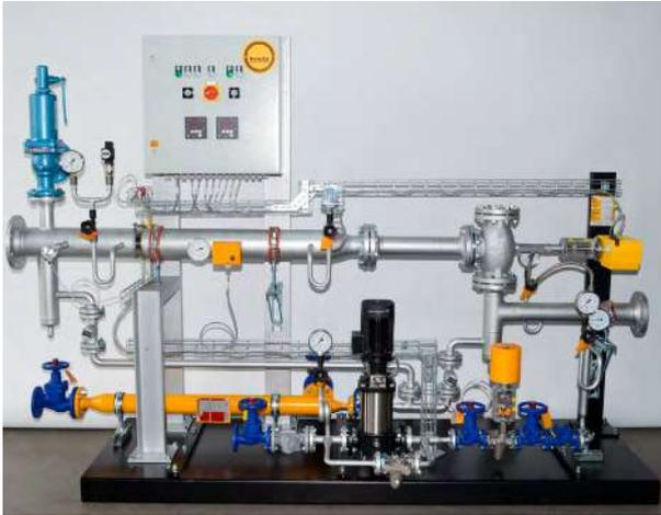
Dampfstrahlpumpensysteme können vormontiert auf einer Konsole (Bild oben) geliefert werden oder als Baelz-Anlage, die beim Kunden vor Ort montiert wird.
