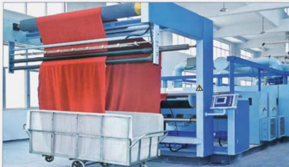
落布系统，可用于完成落布及打小卷。 Delivery system, Feeder with a roller for small roll
